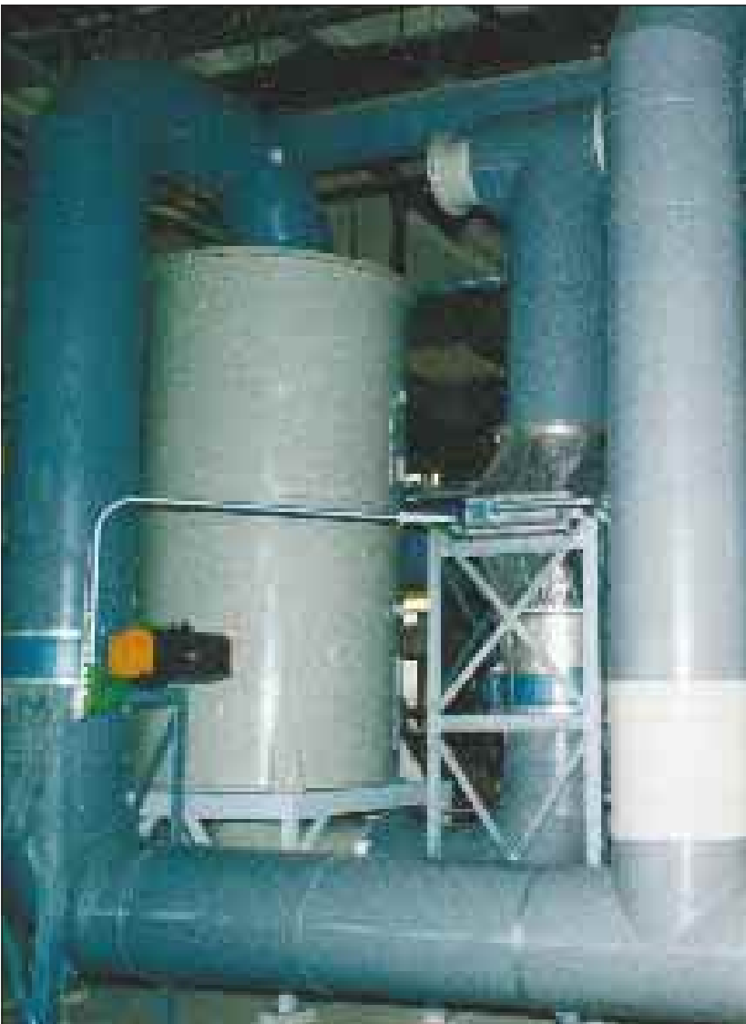
Ringsorber aus PP für eine Abluftmenge von 10.000 m 3 /h als Pufferadsorber mit Wärmetauscher und Bypass für das BIOSORP-Verfahren
