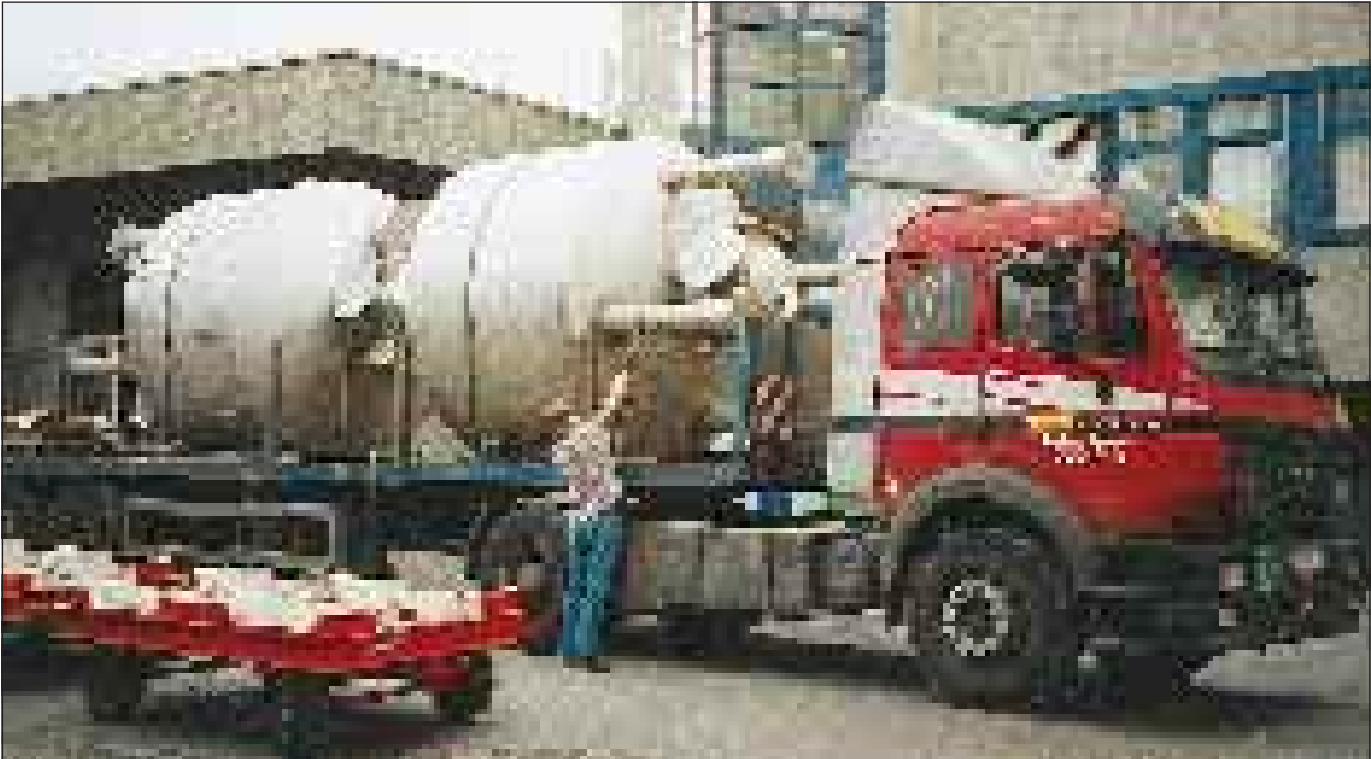
Stehende Festbettadsorber aus 1.4539 für eine dampfregenerierte Adsorptionsanlage zur Reinigung einer Abluftmenge von 6.000 m 3 /h (Lösungsmittelgemische).
